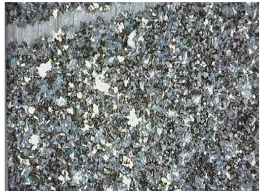
Bild der Oberfläche einer CBN-Schleifscheibe
